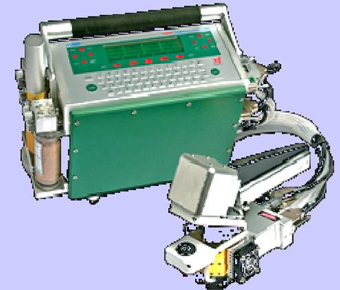
Per ciascuna specie le misure sono state effettuate inserendo le foglie nella cuvetta di un sistema portatile di misura della fotosintesi (LI-6400XT) per determinare
